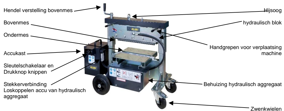
Figuur 4.2-1: Opbouw van de machine
