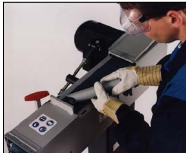
Figura 4.6-1: Plataforma de desbarbado
