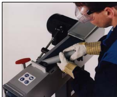
Figura 4.6-1: Plataforma de desbarbado
