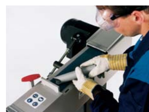
La machine est équipée d'une table d'ébarbage.
