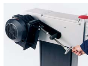
La bande abrasive se met rapidement sous tension.
