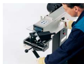
Commande facile pour le réglage de la bande abrasive.
